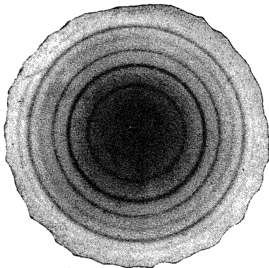
Fig. 7. — FLUORURO SODICO ottenuto per evaporazione nel vuoto della soluzione acquosa.
