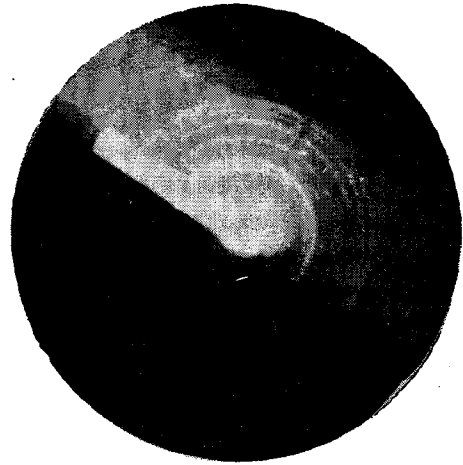
Fig. 17. — OSSIDO DI ZINCO. Metodo dei raggi lambenti due superfici piane.
