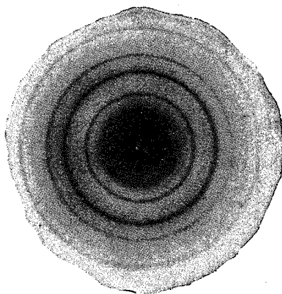
Fig. 12. — BROMURO DI ARGENTO precipitato.
