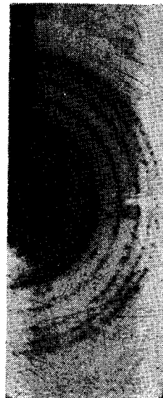
Fig. 19. — OSSIDO DI ZINCO ottenuto dal carbonato neutro. Fotogramma col metodo dei raggi lambenti due superfici piane affacciate.
